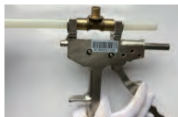
4. Utiliser la mâchoire appropriée puis faire glisser la bague jusqu'à la butée en actionnant la poignée de la pince.
