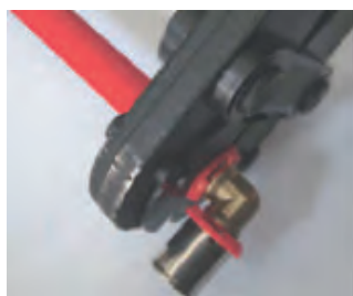
3. Placez le raccord dans la mâchoire. Monter les mâchoires adaptées au profil du raccord sur la pince à sertir
