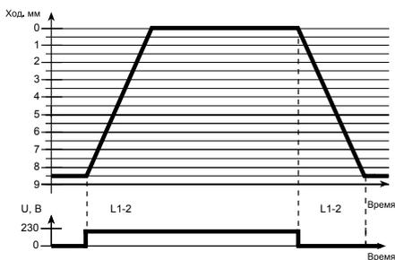
При 2-точечном управлении линия L1-1 (коричневый) должна быть постоянно подключена к фазе. Подача напряжения на L1-2 (чёрный) втягивает шток до конечного положения. Шток остаётся втянутым до тех пор, пока L1-2 находится под напряжением. После отключения L1-2 от фазы шток выдвигается до конечного положения. После достижения конечного положения двигатель сервопривода отключается.
