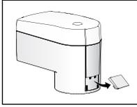
Для защиты от кражи удалите кнопку фиксатора сервопривода.
