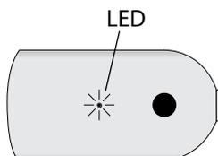
Моторизированный 3-точечный сервопривод оснащен разноцветным светодиодом для индикации рабочих состояний. Отображаемые цвета – зелёный, оранжевый и красный.
