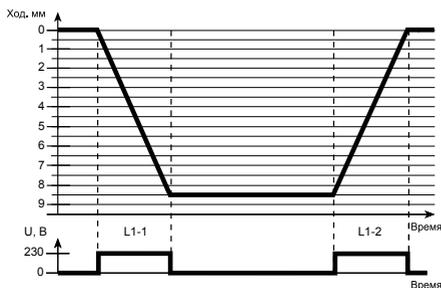
Желаемое направление движения штока выбирается подачей рабочего напряжения на одну из линий (L1-1, L1-2), выдвигая или втягивая его. Подача рабочего напряжения на L1-1 (коричневый) выдвигает шток, подача рабочего напряжения на L1-2 (чёрный) втягивает его. После достижения конечных положений двигатель сервопривода клапана отключается.
