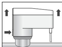
Для снятия сервопривода нажмите на кнопку фиксатора и потяните его от вентиля.
