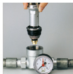
5. Потяните колпачок и вытащите мембрану.
