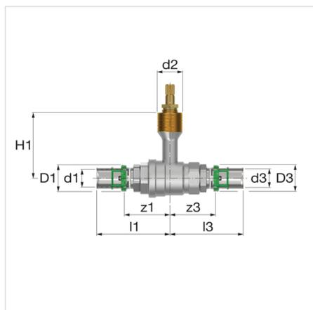
Размеры шарового крана с соединением MultiSkin для монтажа с заделыванием - 7694W
