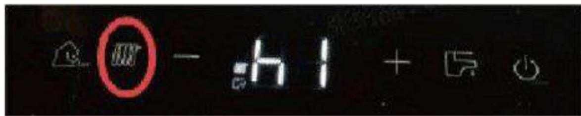
Затем можно нажать кнопку отопления для входа в режим регулировки RH и с помощью кнопок регулировки температуры «+» и «-» отрегулировать давление газа согласно тех. параметрам таблицы стр. 46.
