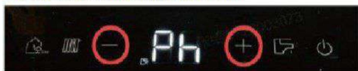
Когда оборудование по умолчанию перейдет в меню настройки минимального давления газа Min, вы можете переключиться в настройку максимального давления газа Max путем регулировки температуры с помощью кнопок «+» и «-».
