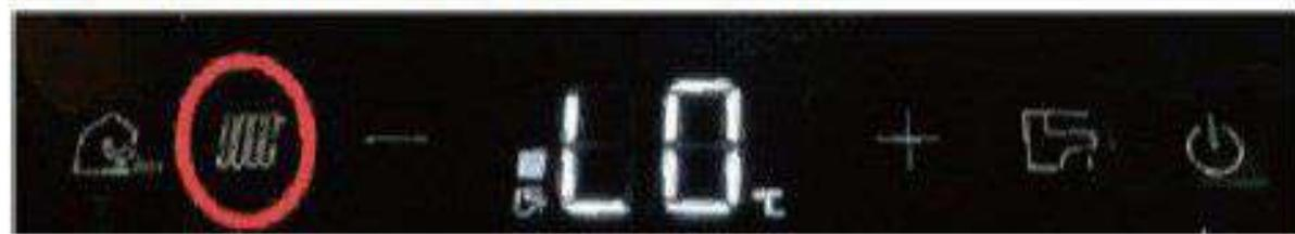
По умолчанию выполняется вход в меню настройки минимального давления газа Min; при нажатии кнопки отопления выполняется вход в режим регулировки PL. Затем с помощью кнопок регулировки температуры «+» и «-» можно отрегулировать давление газа согласно тех. параметрам таблицы стр. 49.
