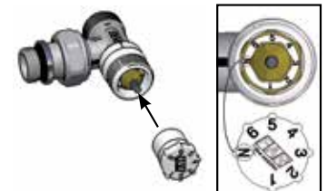
2. Установить ключ регулировки (есть в упаковке) на шток клапана таким образом, чтобы буква N на ключе совпала с буквой N на клапане.
