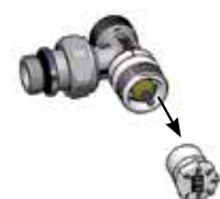
4. Убрать ключ регулировки и установить регулировочную пластиковую ручку или термостатическую головку.
