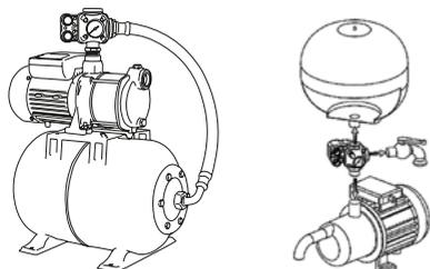
Подключение реле к трубопроводу необходимо проводить с использованием уплотнительных материалов (тефлоновой ленты); оно должно быть герметично, подтекание рабочей жидкости по резьбовой части не допускается.
