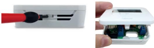
Осторожно снимите переднюю панель и подключите провода.
