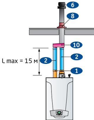
Раздельные трубы с единым вертикальным выводом на наклонную крышу
