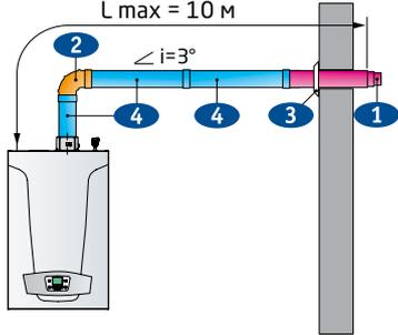
Коаксиальный дымоход с горизонтальным выводом через стену
