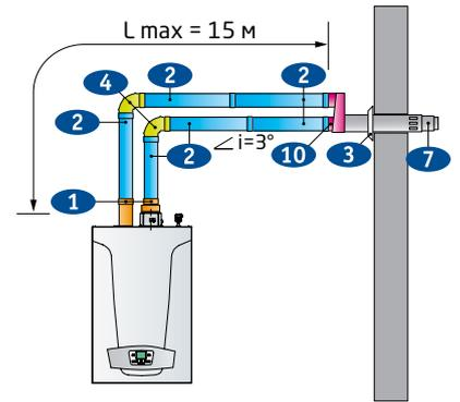
Раздельные трубы с выводом дымовой трубы в дымоход и забором воздуха с улицы
