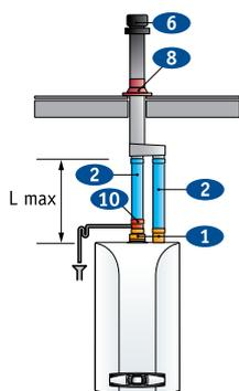
Раздельные трубы с единым вертикальным выводом на наклонную крышу
