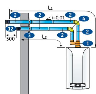
Система с забором воздуха из помещения (B22) и с выводом дымовой трубы через стену
